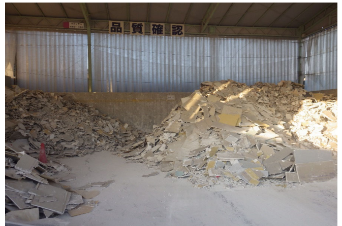
【3 石膏ボード 保管ヤード】
